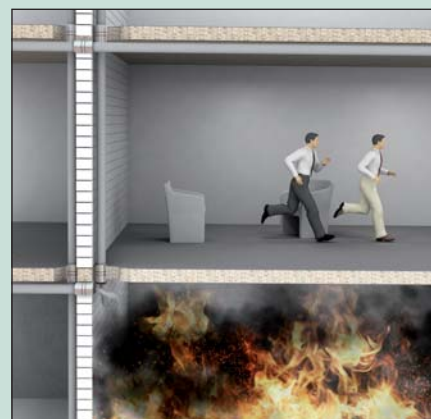
3. Het BIS Pacifyre® MK II Brandmanchet wordt geactiveerd en de aanwezigen hebben tijd om te vluchten
